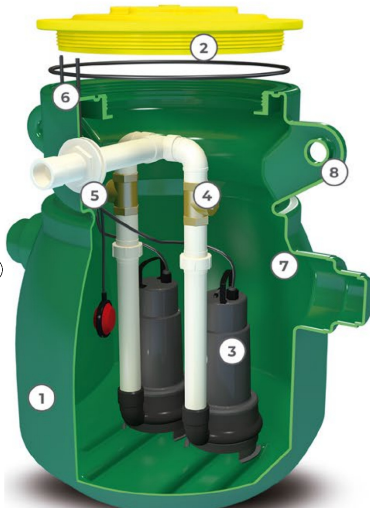
5 | Detalhe - elevatória de esgoto (detalhe 3D) SEM ESCALA
