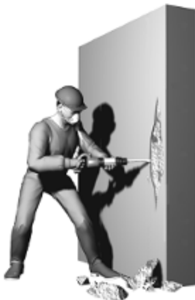
Demolição superficial do concreto.
