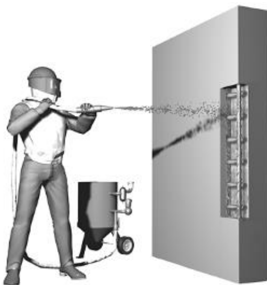
Remoção da corrosão com jateamento abrasivo
