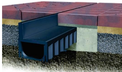
Detalhe de instalação da calha
