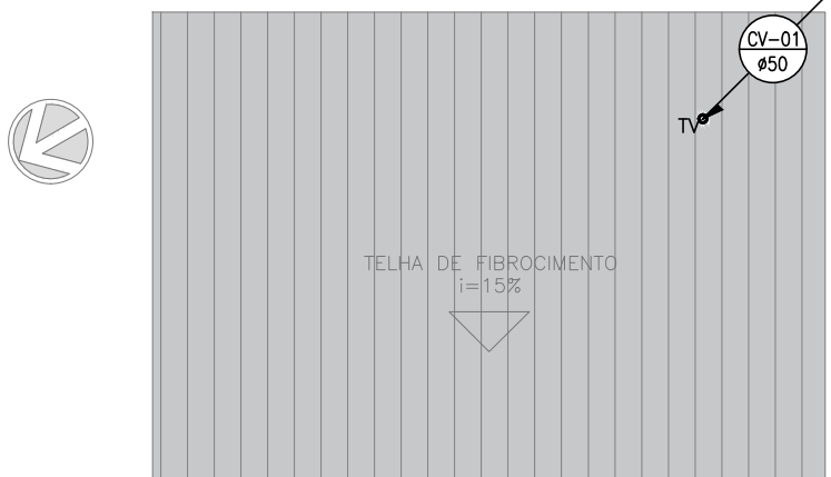
CANTEIRO DE OBRAS PLANTA DE COBERTURA GUARITA ESCALA 1:50
