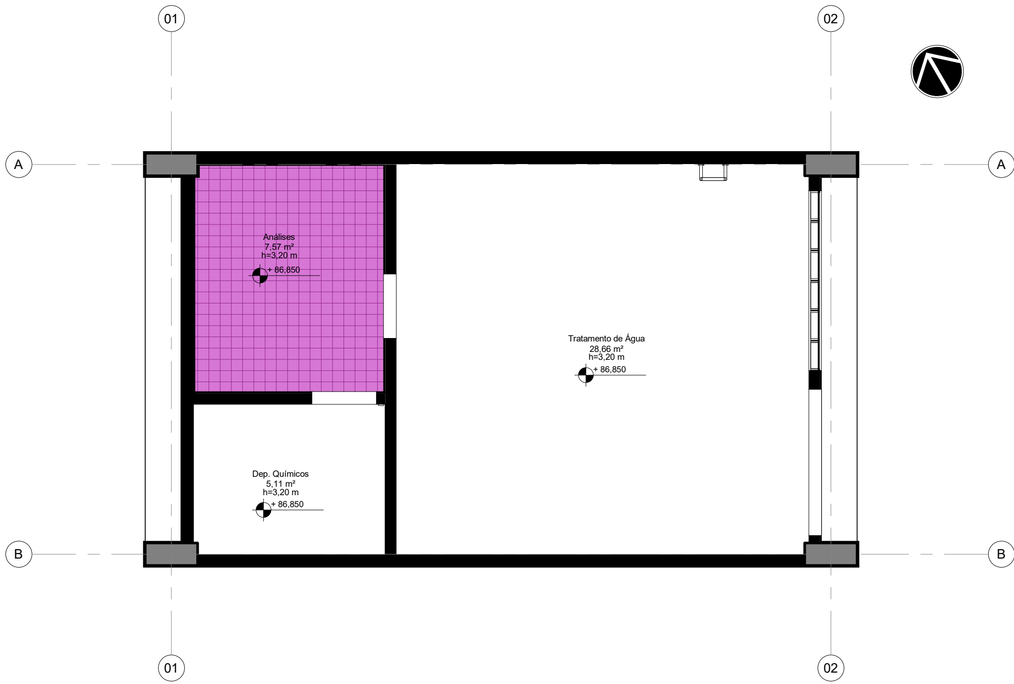
1 | PL. DE IMPERMEABILIZAÇÃO PAV TÉRREO ESCALA 1 : 50
