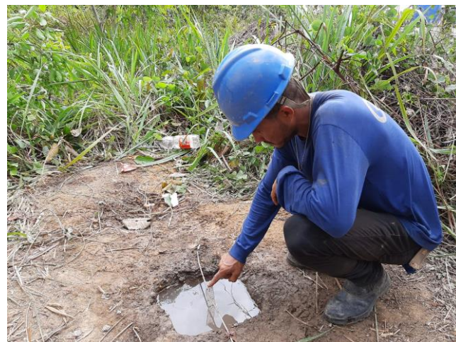
Foto 6 - Após 24h, início medida de rebaixamento do nível d'água
