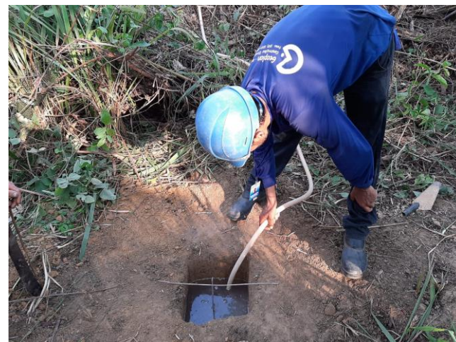
Foto 4 - Colocação de água de modo a saturar o solo
