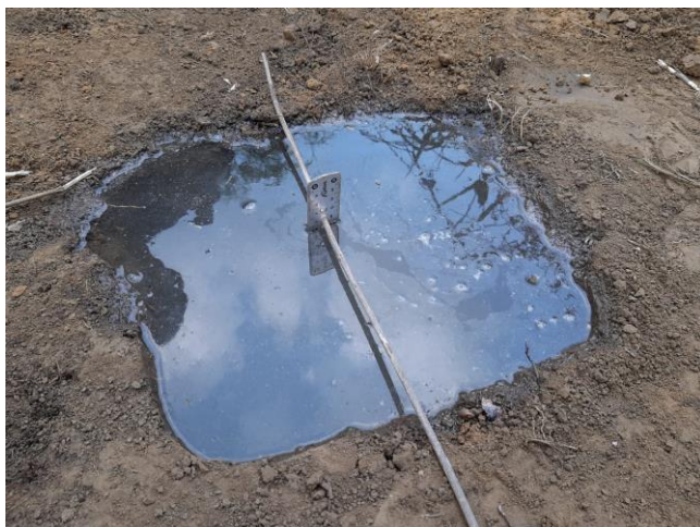
Foto 5 - Processo de saturação do solo
